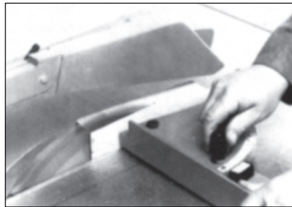
C Werkstück und Winkelanschlag nach vorne schieben. Nach dem Abschnitt Keil- und Winkelanschlag zurückziehen.
